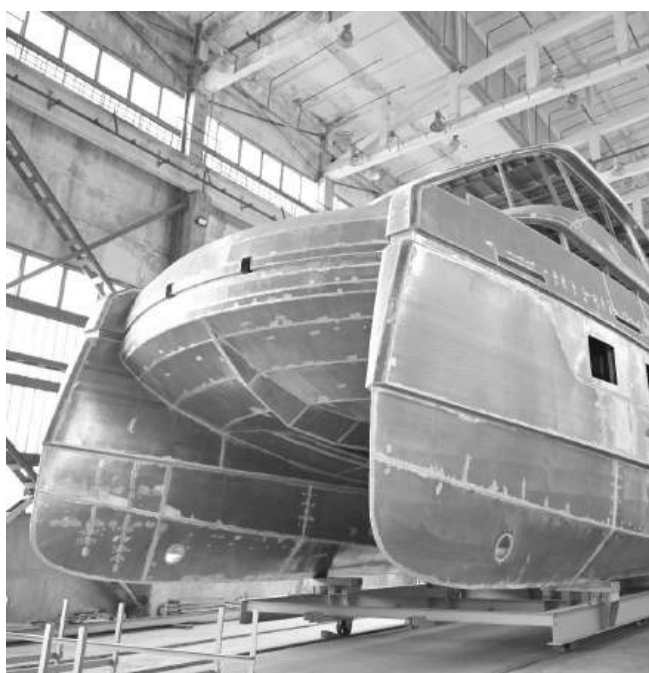
Корпусът на катамарана в производственото хале на фирмата
